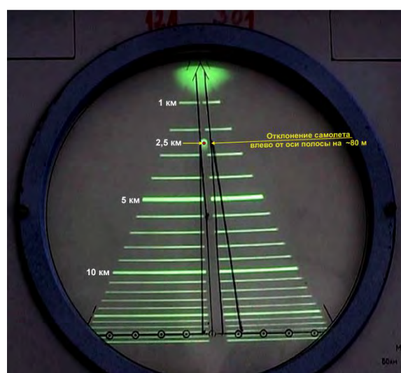
Фото 31. Изображение позиции самолёта относительно глиссады и оси ВПП на индикаторах WISP-75
